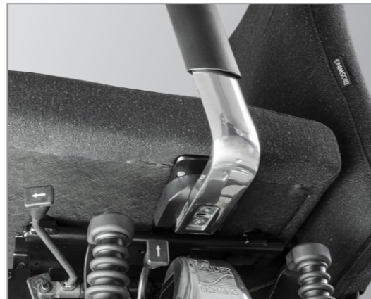
Armlehnen 1F mit Verstärkung und Polyurethan-Hartschaumauflage
